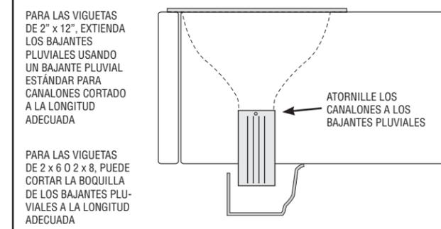
**PARA LAS VIGUETAS DE 2 x 6 O 2 x 8, PUEDE CORTAR LA BOQUILLA DE LOS BAJANTES PLUVIALES A LA LONGITUD ADECUADA**
