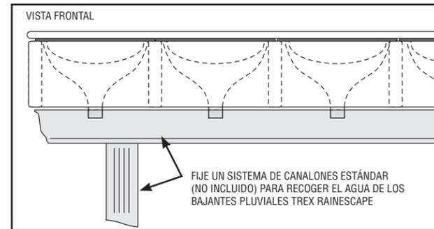
**NOTA:** Instalar un reborde de limpieza le permitirá acceder a la línea de canalones después de la instalación.
