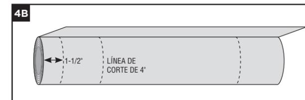
»Si instala el sistema en viguetas con 12" de espacio entre centros, corte 4" del lado de la marca de la línea rasgada de 1-1/2". Luego, alinee el borde izquierdo de la canaleta con la parte externa de la viga (4B).
