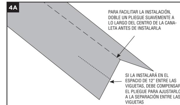
»Cuando trabaje con el material de las canaletas Trex RainEscape, asegúrese de que el lado liso y brillante siempre mira hacia arriba.
