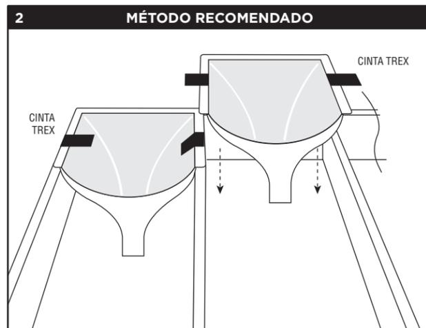
» Coloque tiras de 3" a 4" de cinta Trex para sostener los bajantes pluviales a las viguetas de la terraza.
