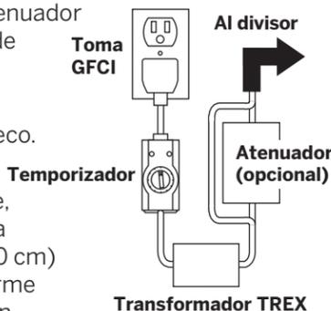
**NOTA:** Consulte un electricista para instalaciones en las que el transformador se conecta a un interruptor de aire acondicionado.
