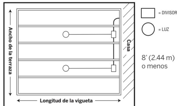
EJEMPLO DE UNA INSTALACIÓN DE 2 FILAS DE LUCES PARA VIGAS ENTRE 9' Y 12' (2.76 - 3.65 m)
