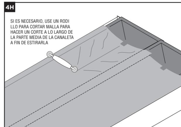
**NOTA:** Cuando la temperatura fluctúe mucho, el material de la canaleta se expandirá y contraerá. Está bien si se arruga un poco, siempre y cuando las arrugas no impidan que pase el agua.
