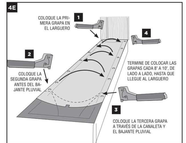
»Desenrolle la canaleta hacia el bajante pluvial usando la línea rasgada de 1-1/2" de la viga interior como guía.
