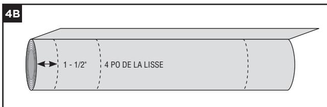
»Si vous installez le système sur une solive de 12 po de diamètre, retranchez de 4 po la rainure latérale de 1 - 1/2 po. Ensuite, alignez le bord gauche de l'auge avec l'extérieur de la solive (4B).
