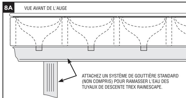
**REMARQUE :** L'installation d'un couvre-joint de purge permettra l'accès à la conduite de la gouttière après l'installation.
