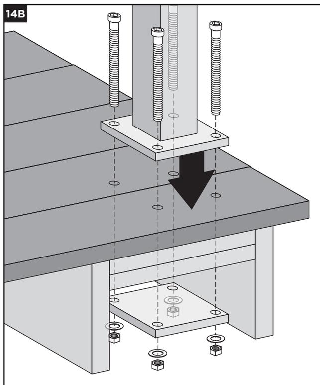
» Fixez le poteau à l'aide de quatre boulons à tête hexagonale de 1 cm x 15,2 cm (3/8 po x 6 po), des rondelles et des écrous, ainsi que de la plaque arrière en aluminium située sous le blocage.
