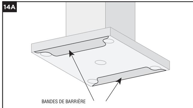
» Insérez les (2) bandes de protection en acier inoxydable sous les trous des boulons de montage. Les bandes de protection ne sont nécessaires que si le poteau est fixé directement à la structure traitée sous pression.
