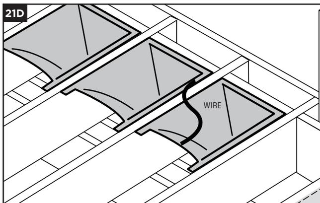
»Faites passer le fil dans l'espace entre l'auge et le tuyau de descente. (21D)
