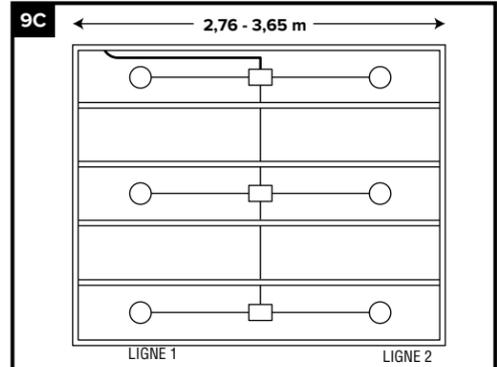
EXEMPLE D'UNE INSTALLATION D'ÉCLAIRAGE À 3 RANGÉES POUR LES SOLIVES ENTRE 3,96 ET 4,87 M
