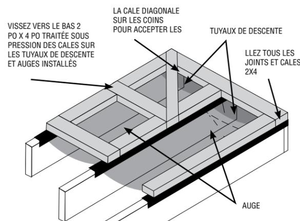
NE PAS UTILISER DES VIS POUR PÉNÉTRER DANS LA CALE DE 2 PO X 4 PO ET PERCER LES TROUS DANS LE MATÉRIEL DE L'AUGE OÙ IL N'EST PAS COLLÉ OU SCELLÉ
