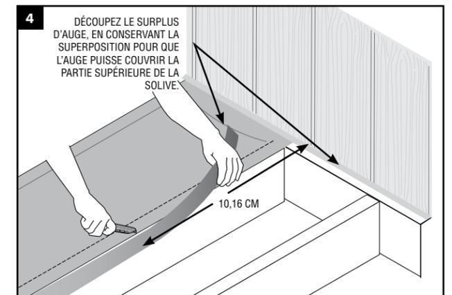
»Prenez des morceaux de 3 à 4 po du ruban butyle Trex RainEscape de 4 po et fixez l'auge tous les 18 po à 20 po, en alternant d'un côté à l'autre. (5)
