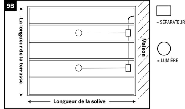
EXEMPLE D'UNE INSTALLATION D'ÉCLAIRAGE À 2 RANGÉES POUR LES SOLIVES ENTRE 2,76 ET 3,65 M
