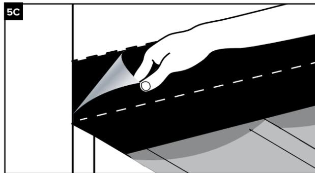
»Une fois que la surface verticale est fixée, retirez le deuxième revêtement de dégagement, dépliez le ruban de lisse Trex Seal et appuyez fermement contre le système Trex RainEscape. (5D)
