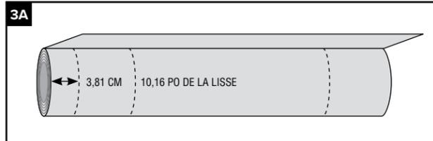
»Si vous installez le système sur une solive 30,48 cm de diamètre, retranchez de 10,16 cm la rainure latérale de 3,81 cm. Ensuite, alignez le bord gauche de l'auge avec l'extérieur de la solive (3B).
