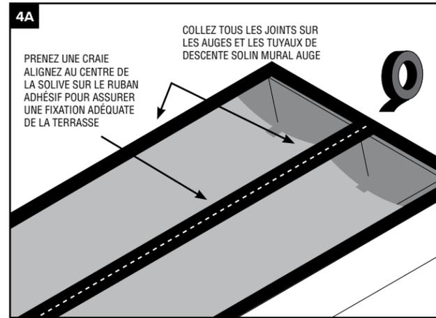
**REMARQUE :** Le ruban butylique ne doit jamais être posé directement sur le bois. Le matériau de l'auge ou un tuyau de descente doit se trouver en dessous
